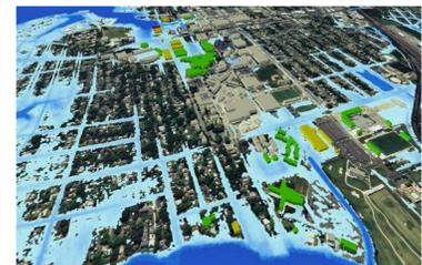
Abb. 5: Beispielhafte Darstellung von Überflutungsflächen und gefährdeter Objekte (aus Allen et al., 2013)
